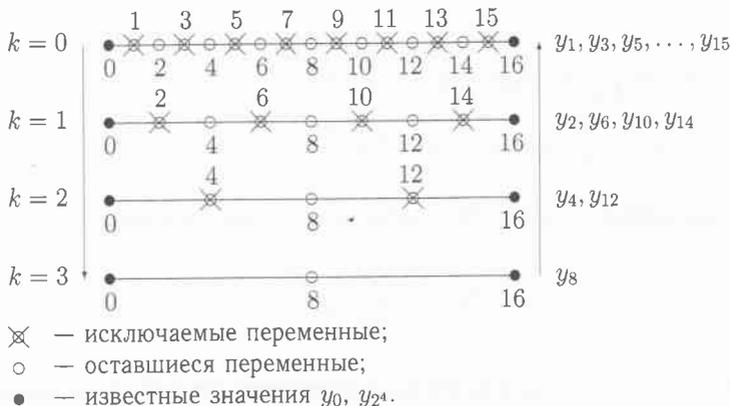
Рис. 3.3. Метод редукции при  $N = 2^4$
